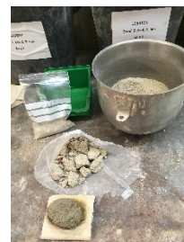
[Bilder aus dem Mörtellabor für die Nachstellung historischer Mörtel, Fa. tubag, Kruft, Sonja Bell, Laborantin]
