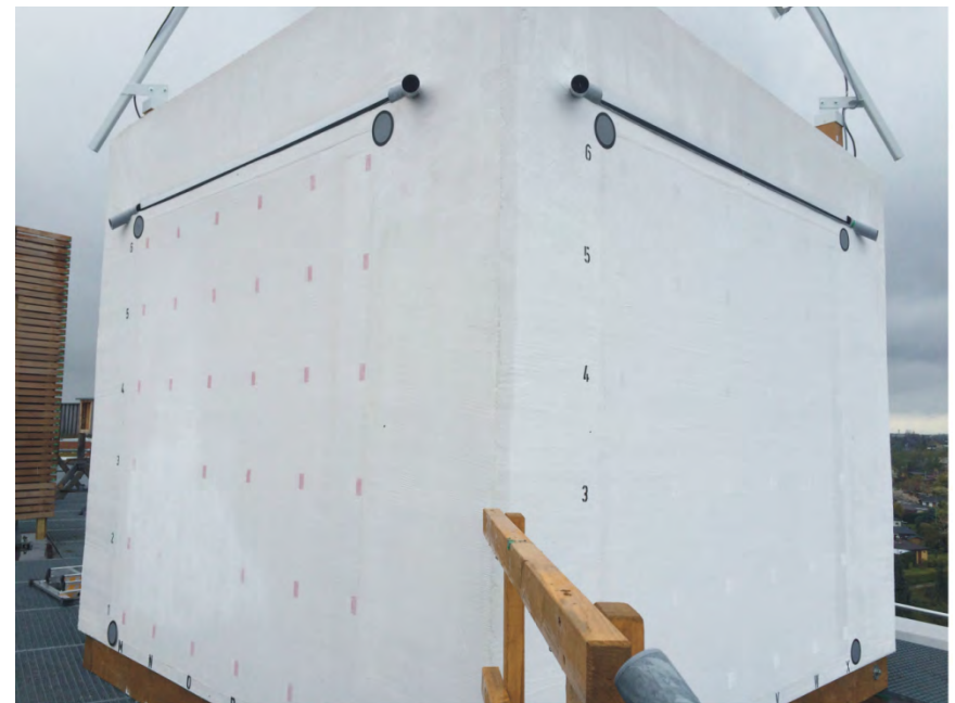
Wandfläche teilweise feucht - Messfelder verfärbt
