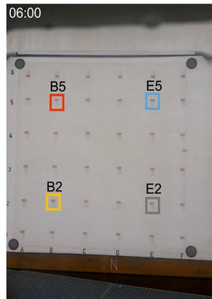
Wandoberfläche nach 1. Regenereignis komplett nass
