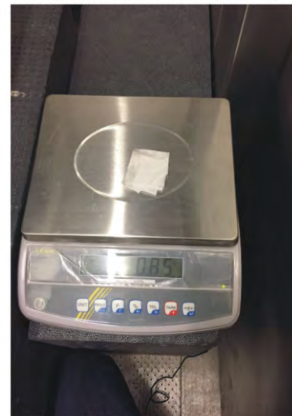
Wiegen des Zellstofftuchs unmittelbar nach Wasserabnahme
