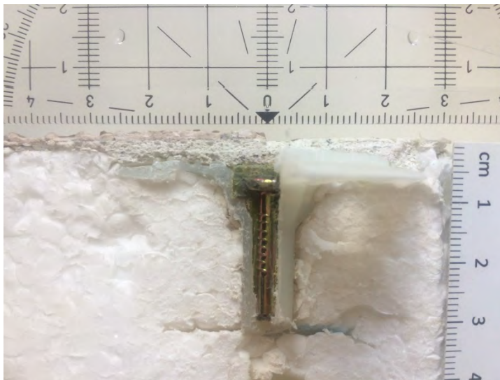
Realer Aufbau am Dübel (Dübelteller aufgeschnitten)
