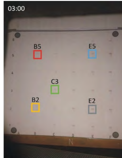
Beginn Tauwasserbildung siehe Felder E2, E5
