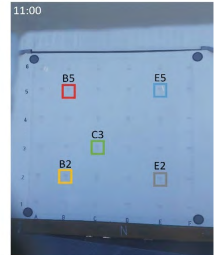
Ende Tauwasserereignis. Wandoberfläche trocken und Feuchtedetektoren wieder weiß
