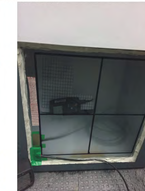
Abnahme des angefallenen Oberflächenwassers im Viertelbereich der Glasscheibe durch Abwischen mit einem Zellstofftuch
