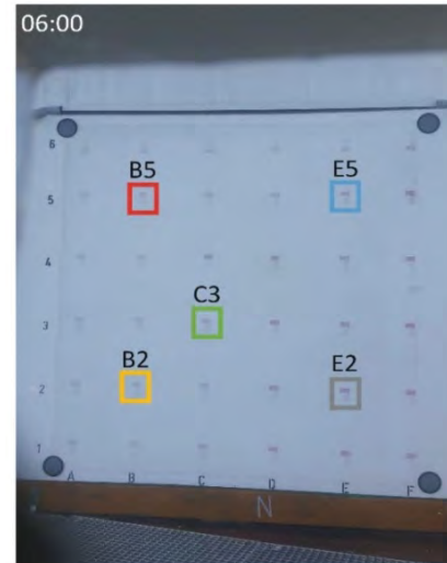
Betaute Wand nach Sonnenaufgang, sichtbar an rot verfarbten Feuchtedetektoren
