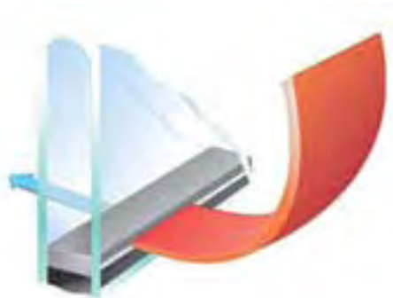
Figuur 2: Warmteverlies langs glasrand (Warm edge spacer)
