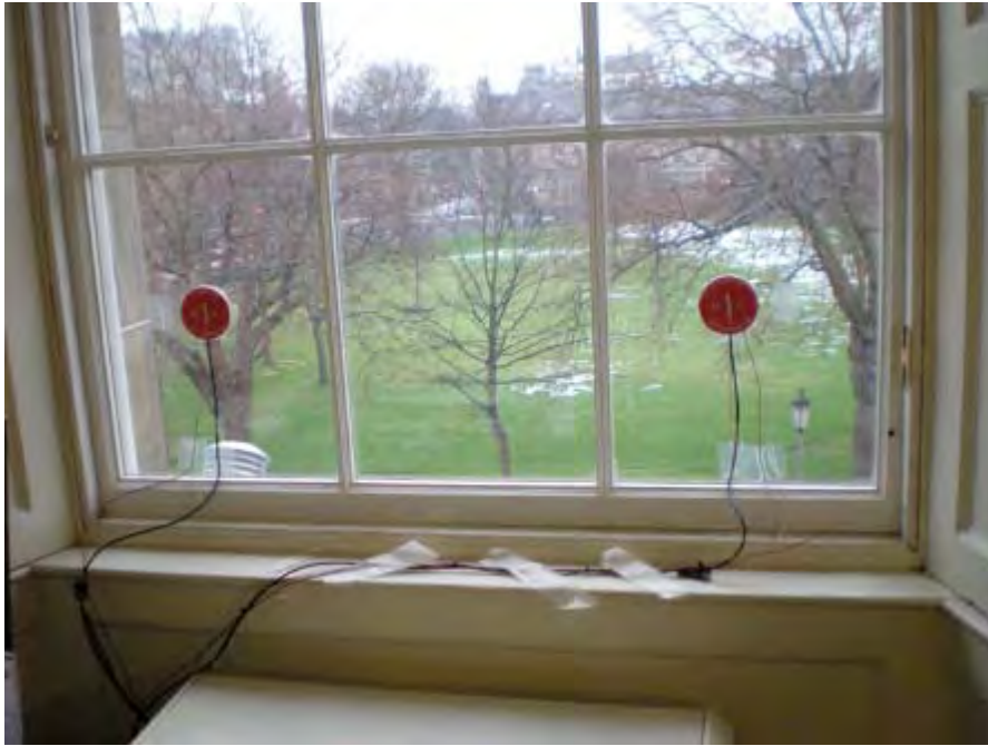
Figuur 20: In situ meting aan dunne, slanke profiel dubbele beglazing. Bron: Baker, 2008
