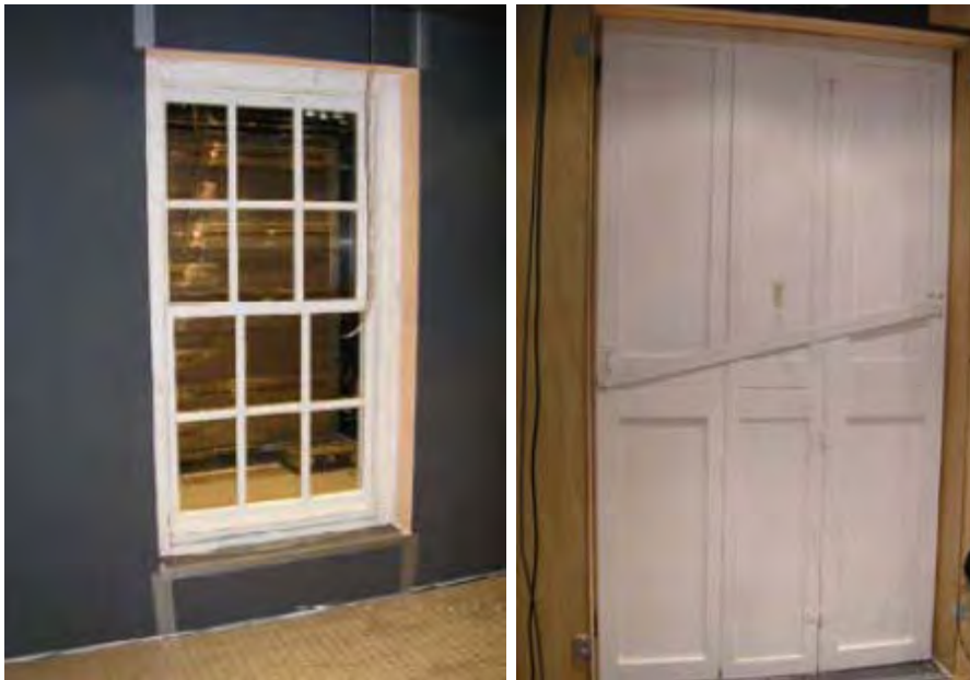
Figuur 17: Proefopstelling van twee (Schotse) raamconstructies in een hot-box. Links: historische Schotse schuifraamconstructie. Rechts: raamconstructie met buitenluiken. Bron: Baker, 2008
