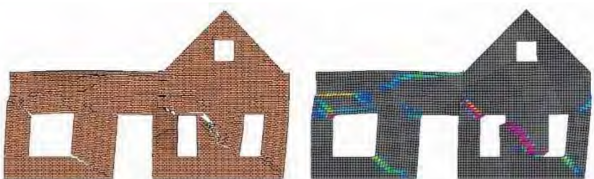
Fig. 4: Details van monotone pushover-analyses van hetzelfde gebouw (fig. 3), gemodelleerd met de steen-voor-steen methode (links) en de 2D-schaalmethode (rechts). Vervormingen zijn vergroot.
