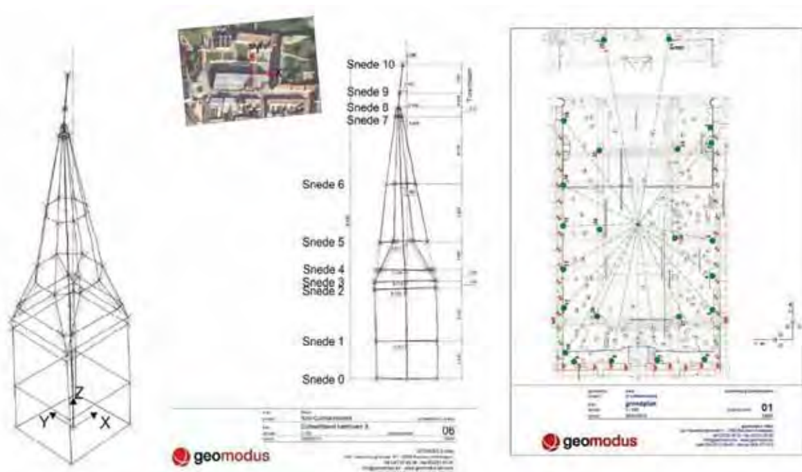
Fig. 4: St-Catharinakerk in Diest: manuele deformatiemeting om de scheefstand van de kerktoeren te bepalen, en een semi-automatische monitoring van de muren van de kerk tijdens en na de funderingswerkzaamheden (zie ook paragraaf 3.1).
