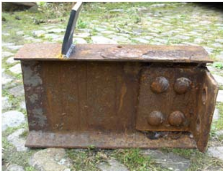
Figuur 7: L-stuk via klinknagelverbindingen aan gording (I-ligger)
