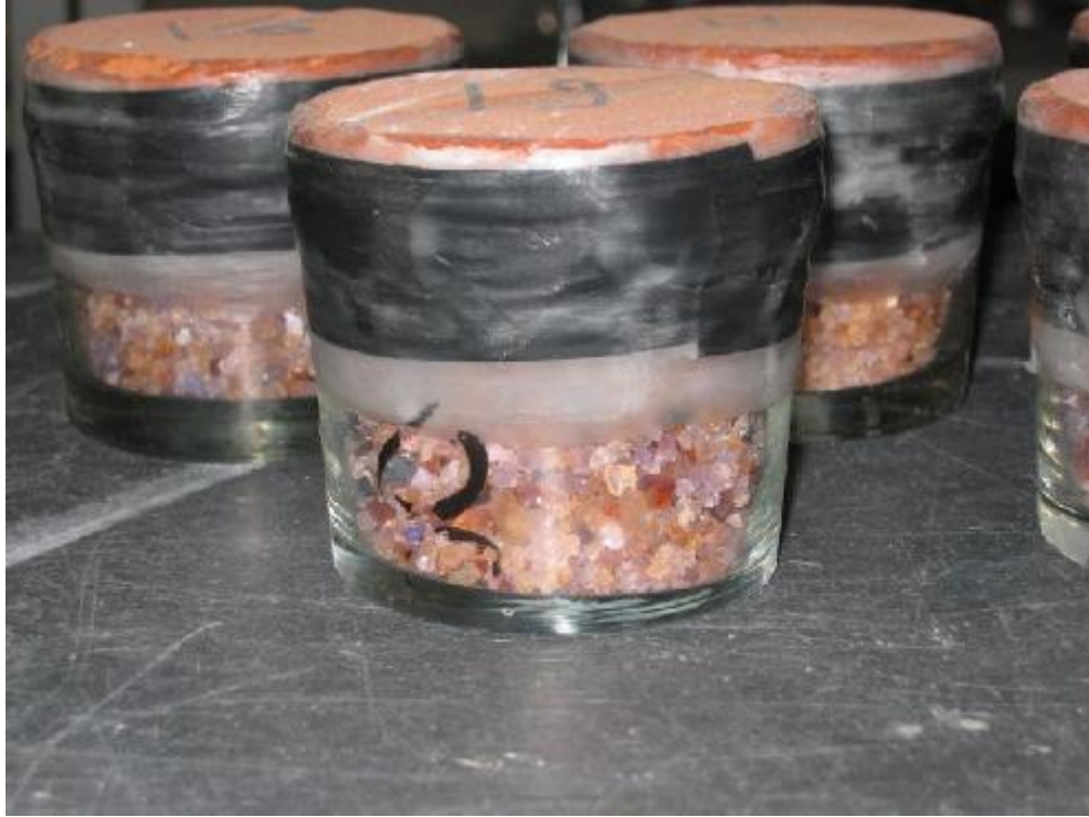
Fig. 10: Proefopstelling voor het meten van de waterdampdoorlaatbaarheid van een antigrffitibescherming
