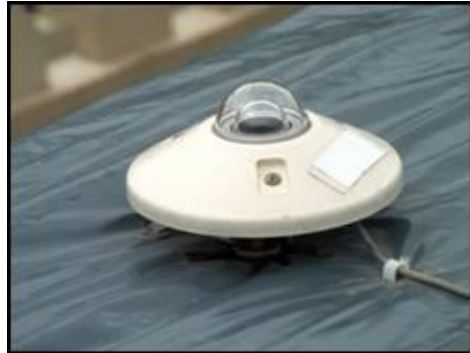
Afb. 3: Meetapparatuur voor het meten van zonneschijn of zoninstraling
