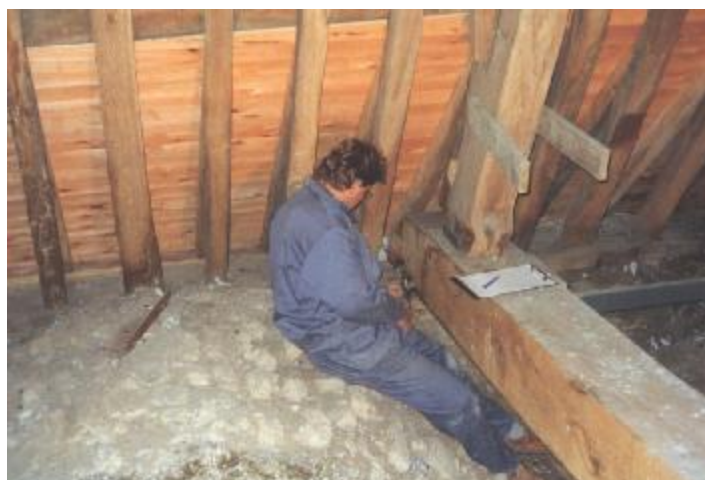
Fig. 24: Convergentiemetingen op zolder St. Catharinakerk
