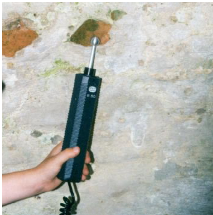
Afb. 3: Elektronische vochtmeter GANN Sensor B 60
