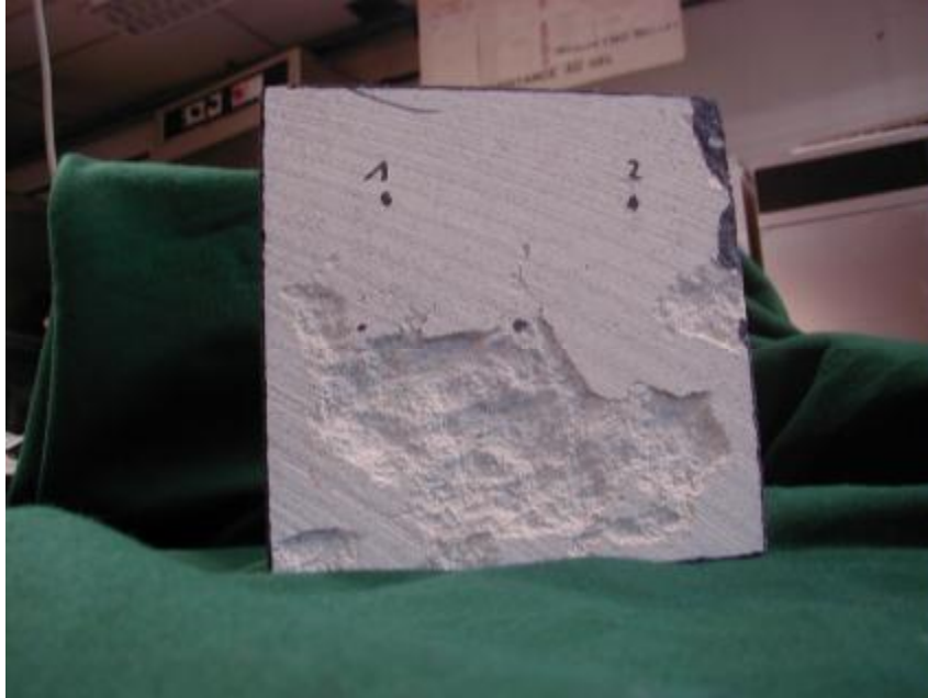
Fig. 4: Het effect van een laboratoriumvorstproef op een kalksteen
