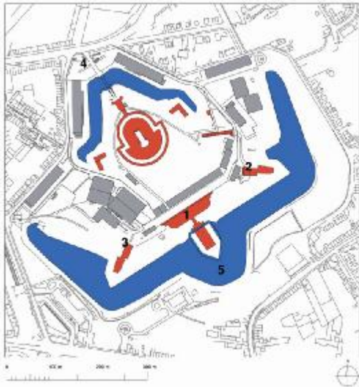
Figuur 1: Grondplan fort 4 Rood: historische gebouwen eerste bouwfase. Grijs: latere toevoegingen 1. Hoofdfrontgebouw, 2. Linker Half Caponnière, 3. Rechter Half Caponnière. 4. Toegang Fort en 5. Gracht met water.
