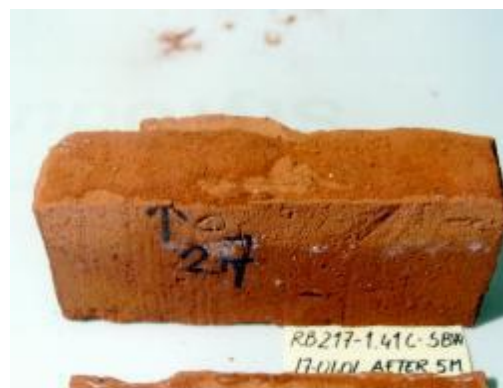
Figuur 10: Droge plekken (hydrofobering is effectief) en natte plekken (hydrofobering niet/onvolledig effectief) op het beschadigde oppervlak. Verondersteld wordt dat de natte zones verklaard kunnen worden door de bevochtigende eigenschappen van NaCl aanwezig in de fijne poriën
