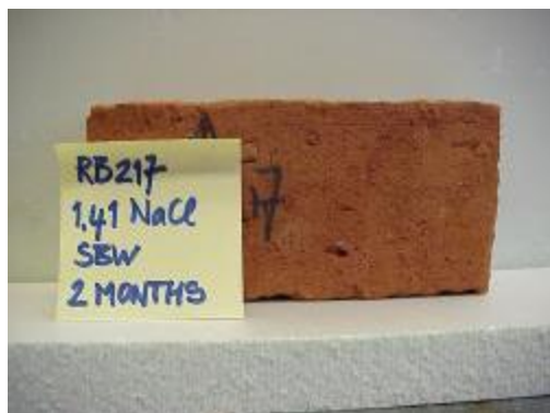
Figuur 8: Schadeontwikkeling in gehydrofobeerde baksteen, belast met NaCl: horizontale scheur na 2 maanden; volledig loskomen van de laag na 5 maanden.
