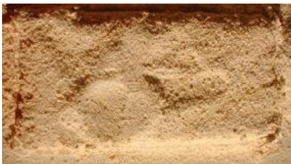
Figuur 7A: schade aan onbehandelde oölitische kalksteen gecontamineerd met natriumsulfaat
