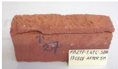
Figuur 8: Schadeontwikkeling in gehydrofobeerde baksteen, belast met NaCl: horizontale scheur na 2 maanden; volledig loskomen van de laag na 5 maanden.
