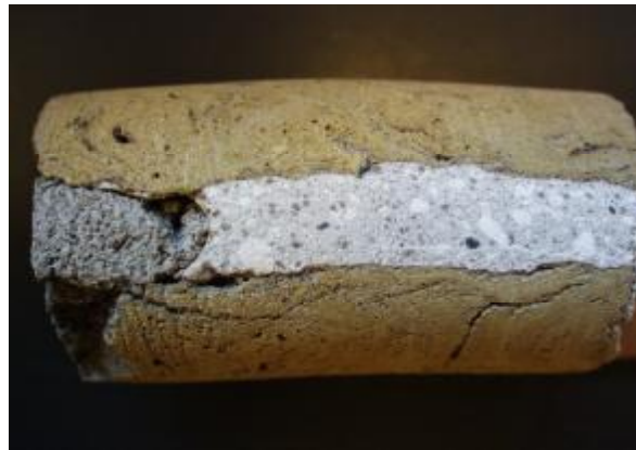
Figuur 8: Dichte cementvoeg incompatibel toegepast op een kalk metselmortel. Krimpscheur tussen voeg en bovensteen; holte tussen voeg en metselmortel
