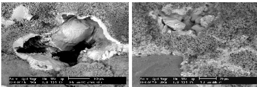
Figuur 12: NaCl, afgezet als een laag op de wanden van wijde poriën. Een en ander na schade in een labexperiment.
