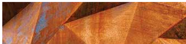
Obř. 14: Corten – moderní materiál, který využívá stabilizovanou korozní patinu jako funkční i vizuální prvek.
