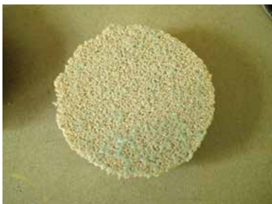
Obr. 5 Způsob porušení při zkoušce přidrženosti epoxidové drenážní sěrky při plnění nad 92 %.
