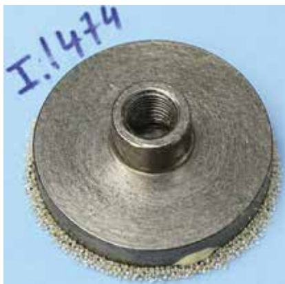
Obr. 3 Zkušební terč pro stanovení přidrženosti sěrky k podkladu.
