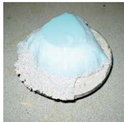
Obr. 4 Způsob porušení při zkoušce přidrženosti epoxidové drenážní sěrky při plnění do 92 %.
